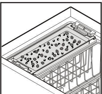
La tablette de congélation peut être posée sur le corbeille ou glissée dans la cuve pour servir de cloison de séparation.
