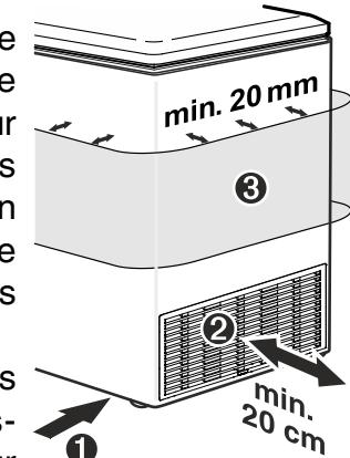
③ Ne pas déplacer le corps de l'appareil. La distance minimale autour de l'appareil doit être de 20 mm afin d'assurer une bonne dissipation de la chaleur.
