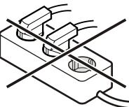
Ne pas utiliser d'onduleurs (conversion du courant continu en courant alternatif resp. triphasé) ou de "fiches économie d'énergie". Risque d'endommagement du système électronique !
